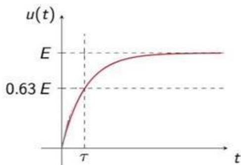
La tension électrique aux bornes d'un condensateur lors de sa charge s'exprime selon la relation :
