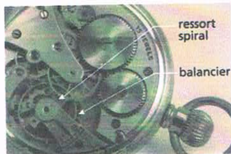
Fig. 4 Les balanciers des montres sont des pendules élastiques utilisant un ressort spiral.
