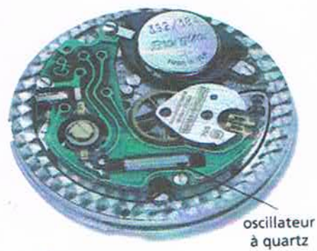
Fig. 7 Intérieur d'une montre à quartz.
